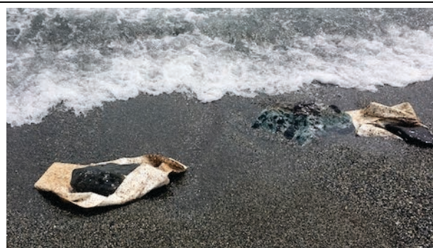
Foto 5. Particolare del tampone oleoassorbente posizionato nel bagnasciuga e contaminato con idrocarburi
