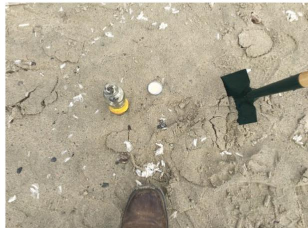
**Foto 5.** Riempimento del contenitore di campionamento
