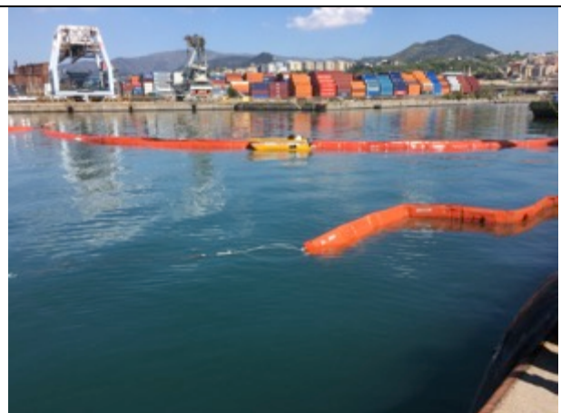
Foto 6. Movimentazione panne rigide oceaniche
