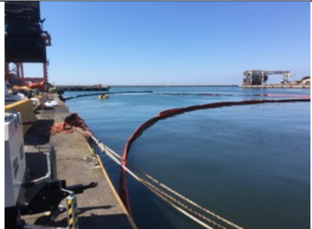
Foto 4. Recupero in banchina panne gonfiabili oceaniche
