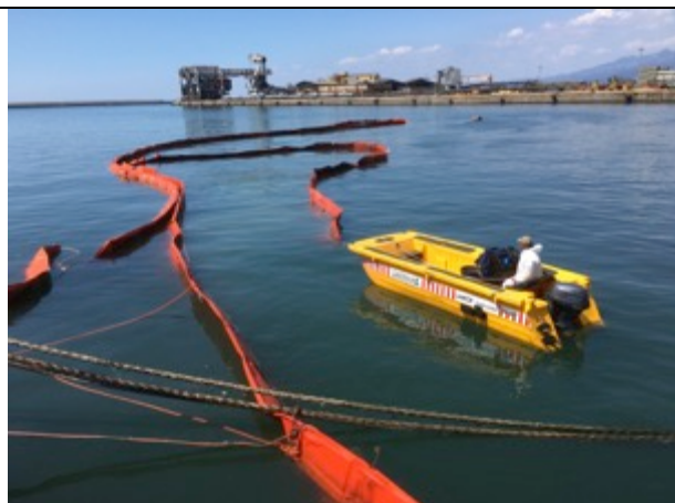
Foto 5. Movimentazione panne rigide oceaniche
