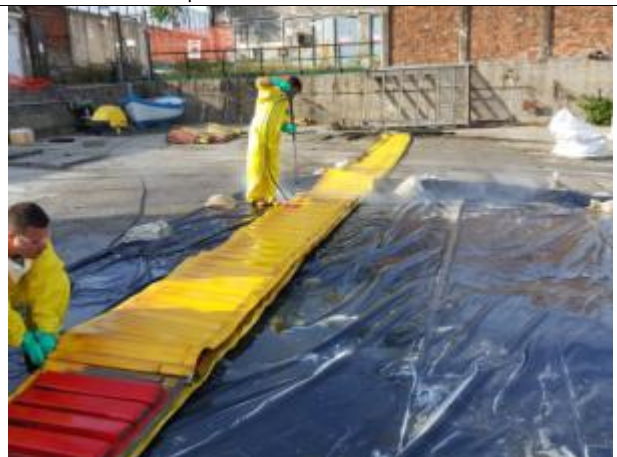
Bonifica dei due lati della barriera galleggiante IPLOM
